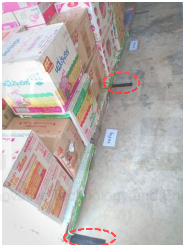
ภาพที่ 4.8 แสดงตำแหน่งการจัดเก็บสินค้าโดยใช้แถบสีที่เป็นสีของป้ายชื่อร้าน
