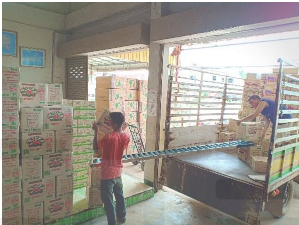
ภาพที่ 4.4 แสดงการใช้ลูกกลิ้งลำเลียงในการขนถ่ายสินค้าจากรถบรรทุกเข้าคลังสินค้า
