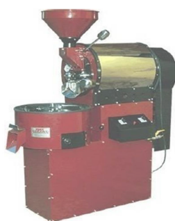
ภาพที่ 2.1 เครื่องคั่วเมล็ดกาแฟที่ใช้แก๊สหุงต้มในการให้ความร้อน
