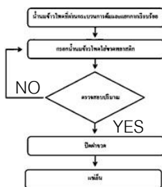
รูปที่ 2 แสดงขั้นตอนการทำงานของกระบวนการบรรจุ
