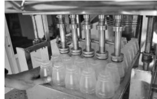
รูปที่ 5 ลักษณะของการบรรจุโดยใช้หัวบรรจุแบบแกรวิตี้
