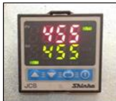
ภาพที่ 4.7 อุปกรณ์ควบคุมอุณหภูมิความร้อนรวมระบบ
